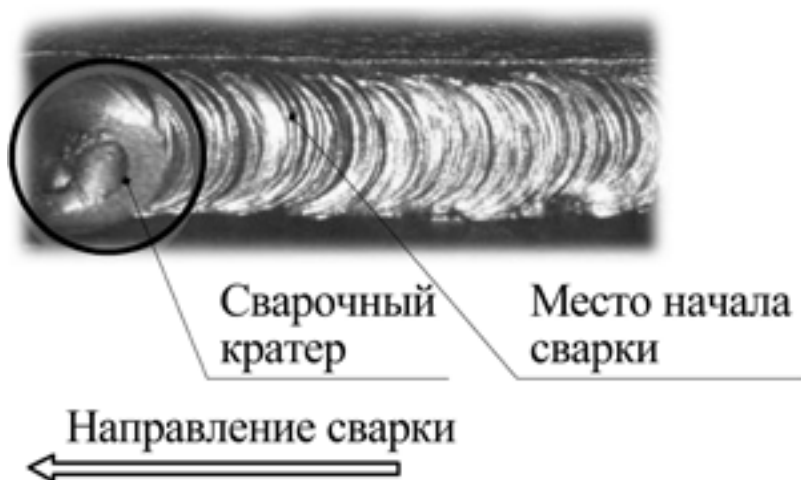
Рис. 9.4. Начало сварки при смене электрода.
