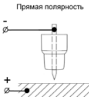
Рис. 8.6. Полярность при TIG сварке.
